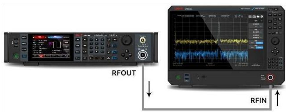
图 3-10: 获取单一信号的仪器设置
